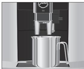
При выключении кофемашины Е6 промывка системы выполняется автоматически, если была использована функция приготовления кофейного напитка.
